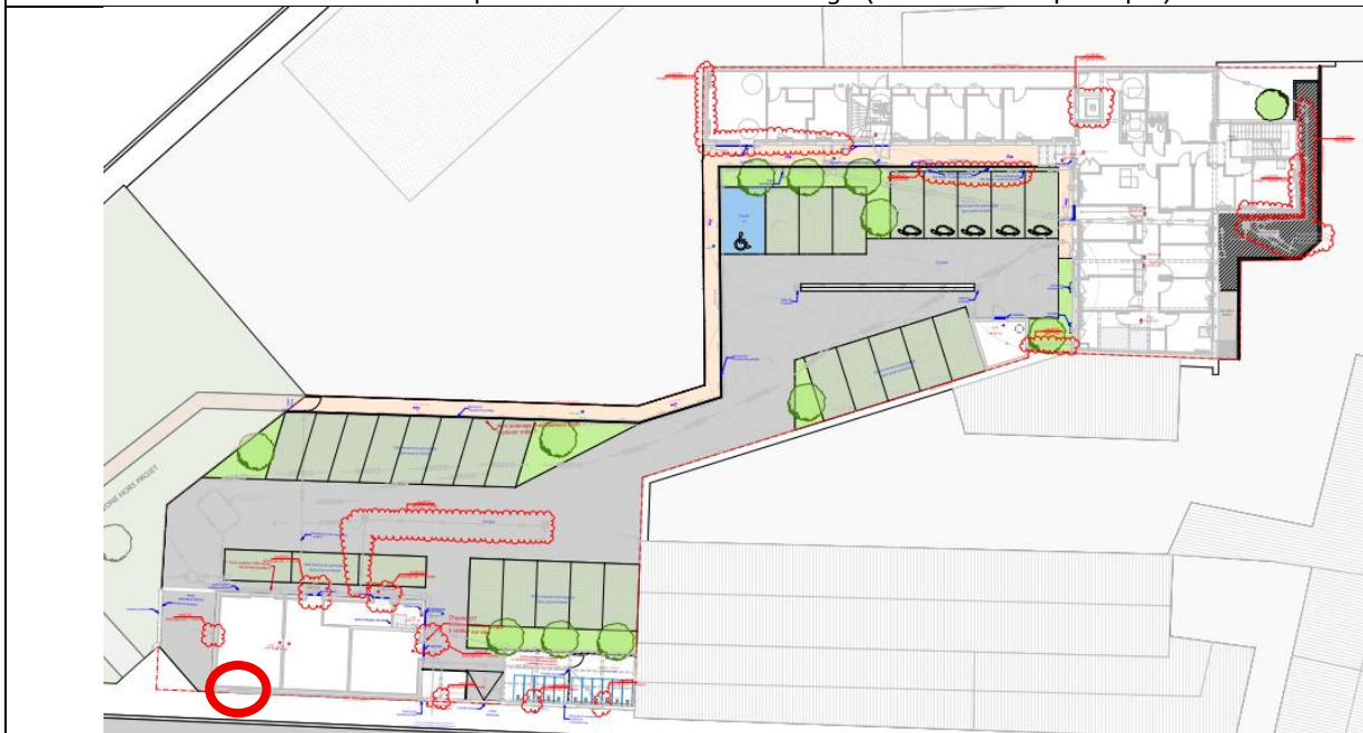
Positionnement prévu TGBT encerclé en rouge (RdC bâtiment principal)
